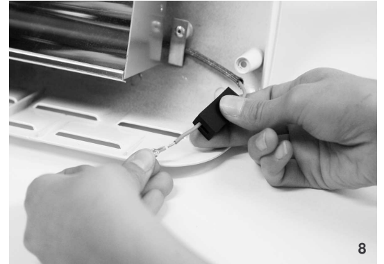
8. ВСТАВЬТЕ НОВЫЕ РАЗЪЕМЫ И ПРИЖМИТЕ ИХ В МЕСТЕ СРЕЗА ПРОВОДОВ. ВНИМАНИЕ: НЕ ДОТРАГИВАТЬСЯ ДО ЛАМПЫ ГОЛЫМИ РУКАМИ.
